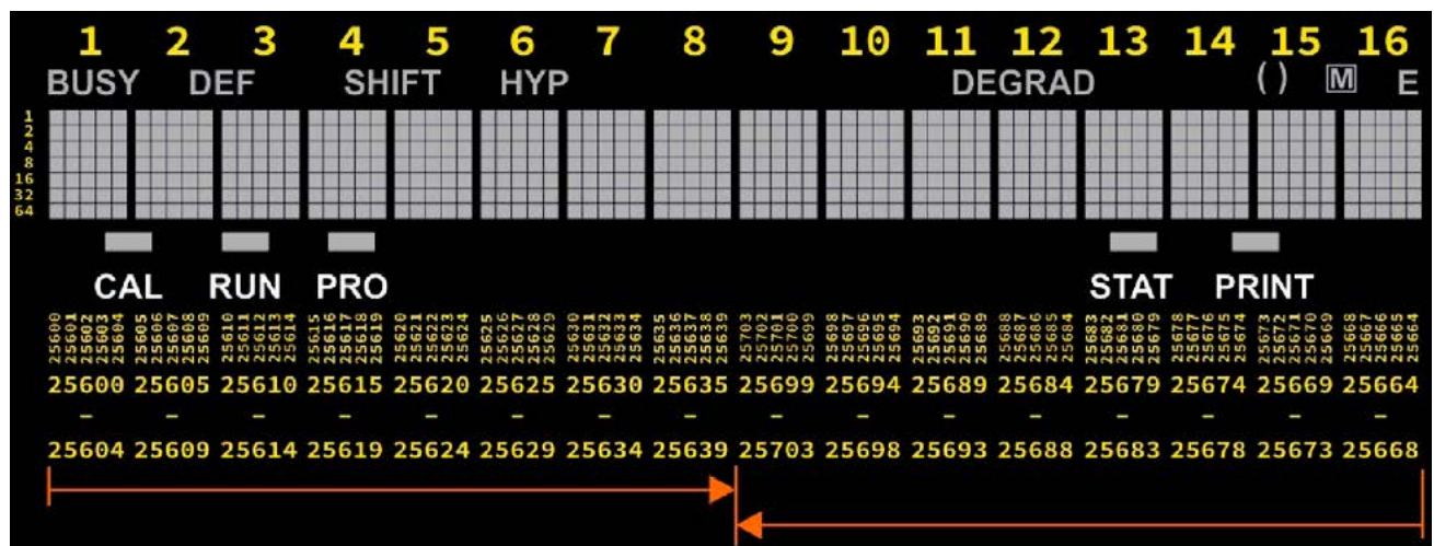
Sharp PC-1401:n näyttöalue(harmaa) ja sitä vastaavat muistialueet (Walter Fischer, cavefisher.at/spc/html/Info_PC-1402.html )
